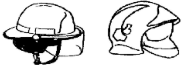
Figura n.º 44 — Capacete de protecção tipo 2, a que se refere o artigo 44.º
